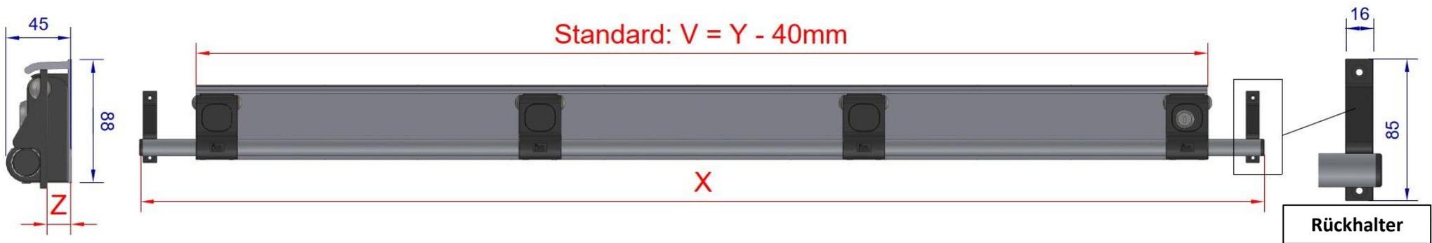
**Gummipuffer auf der Oberseite** können statt den Rückhaltern als oberer Endanschlag verwendet werden. Die Puffer schlagen an der oberen Blende des Fahrzeugs an.
