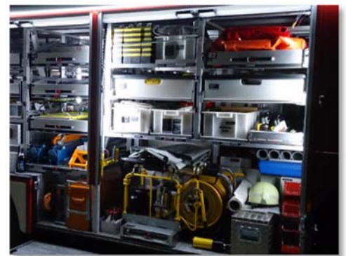
Geräteraum mit seitlich vertikal angeordneten Interior-Lichtleisten:
